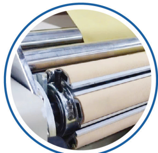
Trục lăn EFR mới: Giải pháp tối ưu cho vải mềm- nhẵn, đặc biệt là dệt kim (tùy chọn). New digital tension control system with servo motor: Precise control.
