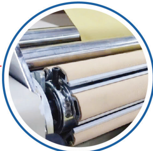
Trục lăn EFR mới: Giải pháp tối ưu cho vải mềm- nhẵn, đặc biệt là dệt kim (tùy chọn). New digital tension control system with servo motor: Precise control.
